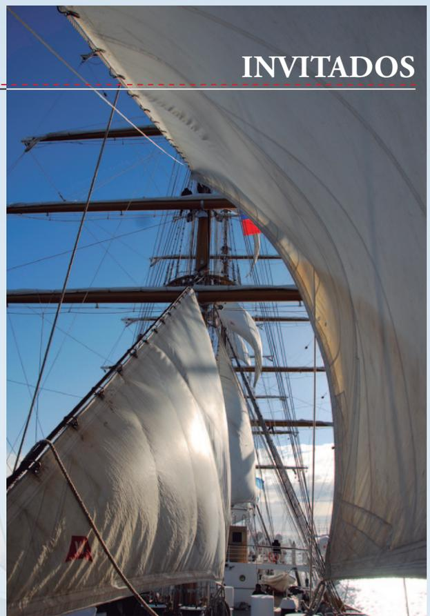
La Libertad es una fragata de tres palos (trinquete, mayor y mesana) y bauprés. Los palos son de aceros y están formados por macho y mastelero. La sección es circular, construida con planchas de acero soldadas de espesor variable entre 9,5 y 12 Mm. La planta propulsora está formada por dos motores diesel de 1200 HP.
